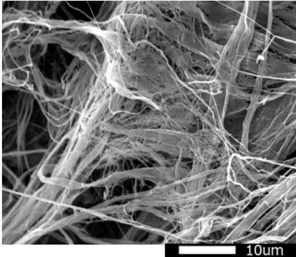
植物繊維を原料として独自の技術により作成した、微細な繊維形状を有するマイクロフィブリル化セルロースです。高いアスペクト比を持つことを特徴とし、再生可能な資源で環境負荷が低く、持続可能な素材です。
